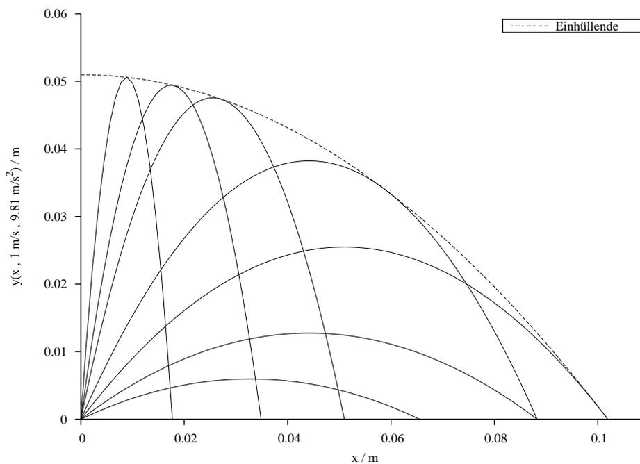
Abbildung 2: Wurfparabeln zu verschiedenen Abwurfswinkeln  $\alpha$  mit zugehöriger Einhüllender für  $v_0 = 1 \frac{\text{m}}{\text{s}}$  und  $g = 9,81 \frac{\text{m}}{\text{s}^2}$
