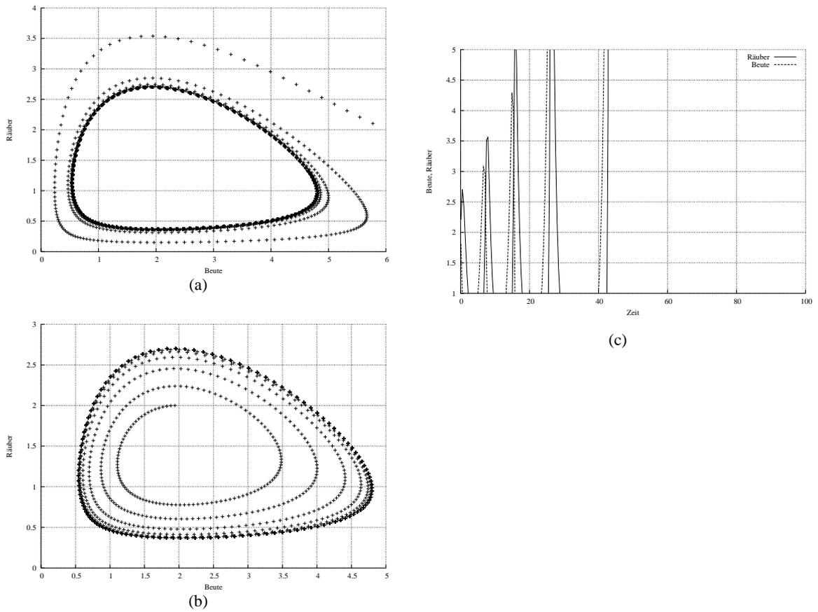
Abbildung 2: Phasendiagramme (a), (b) und Zeitdiagramm (c) des Räuber-Beute-Modells mit den Parametern  $(\delta, \kappa, \varepsilon) = (1, 0.5, 0.15)$
